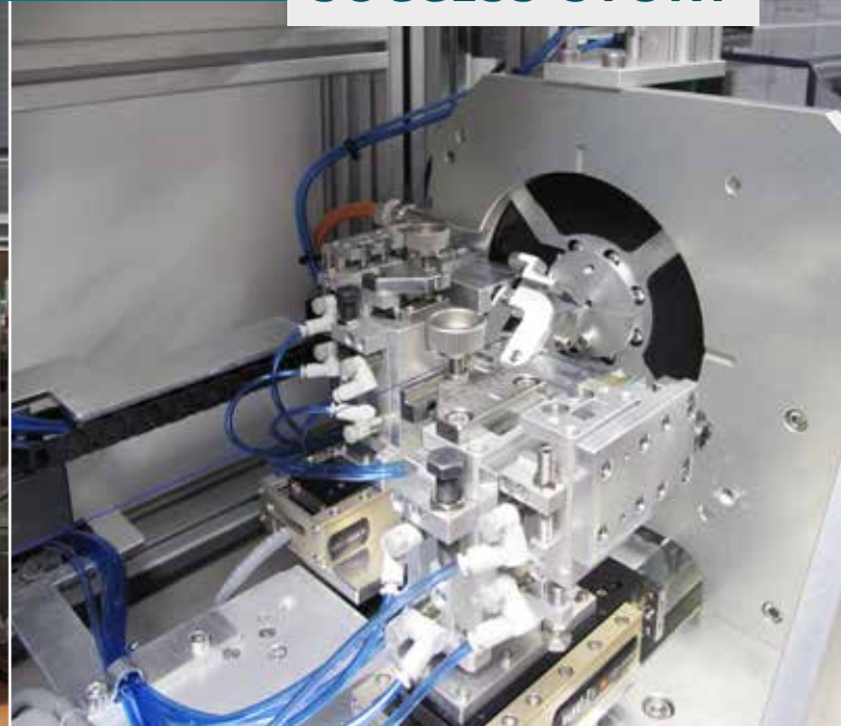
Herzstück der Anlage: der Fadeneinzug und -zusschnitt
